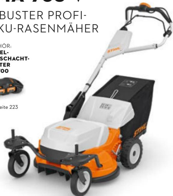
Zur regelmäßigen Pflege von Rasenflächen in besonders lärm-sensiblen Bereichen wie z. B. in Wohnanlagen, Schulen oder Krankenhausgärten. 63 cm Schnittbreite, 2-Messer-Mähwerk strömungsoptimiert, radweise Schnitthöhenverstellung, elektrischer Vario-Radantrieb sowie höhenverstellbarer und klappbarer Komfortlenker. 80-Liter-Grasfangkorb mit Füllstandsanzeige.
