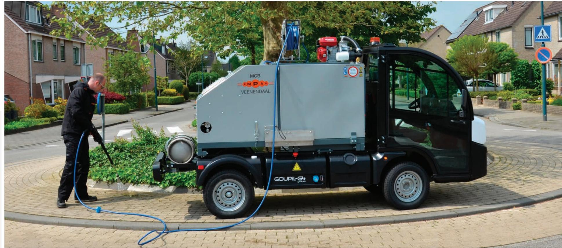
MCB MIT ELEKTRO-MOTOR AUF ELEKTROFAHRZEUG
